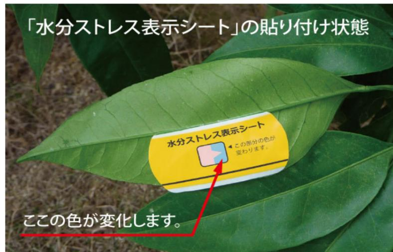
**特長 :** 樹が水分ストレス状態になると、葉の裏の気孔が閉じて蒸散量が減少します。この原理を利用して、樹の水分ストレス状態を簡易に判定するものです。高品質果実を安定生産するための灌水の指標として利用できます。
